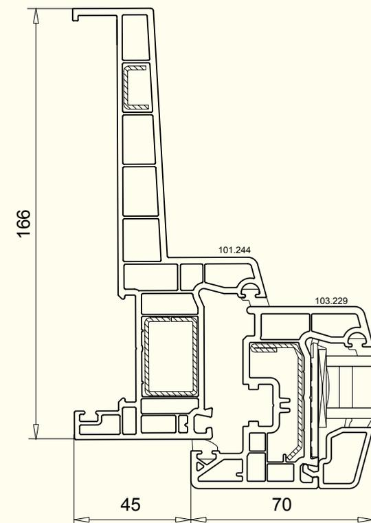
**OptiLine VEKA 70 CON TELAIO DI RISTRUTTURAZIONE**
