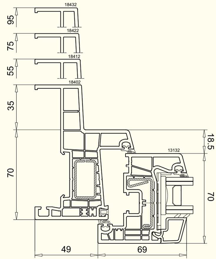
OptiLine CORTIZO A70 CON TELAIO DI RISTRUTTURAZIONE
